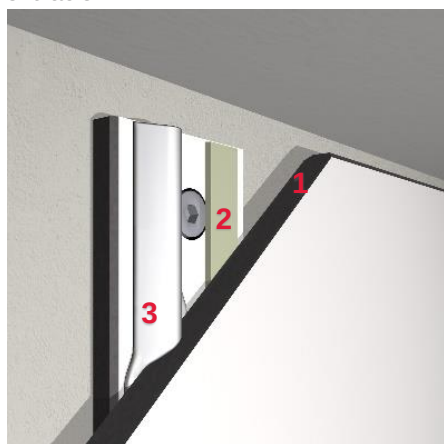
Imagen 30: Encolado superior del revestimiento de pared
