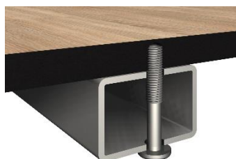
Imagen 40: Fijación recomendada del tablero compacto
