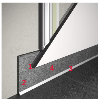
Imagen 31: Encolado inferior del revestimiento de pared
