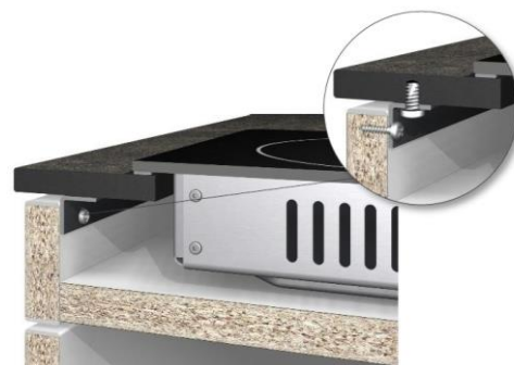
Imagen 49: Estabilización con travesa metálica
