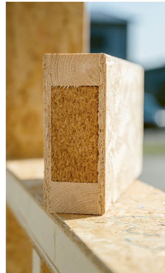
Die EcoBox ist ein Hybridprodukt aus OSB, Schnittholz und Holzweichfaserdämmung. Dieser effiziente Materialverbund senkt den Holzverbrauch.
