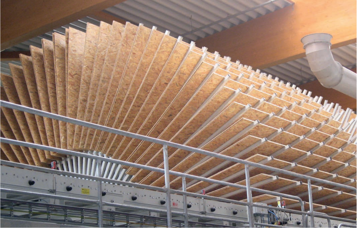
Yüksek kalite talepleri: EGGER fabrikasındaki yıldız soğutucu ünitesindeki OSB levhaları.
