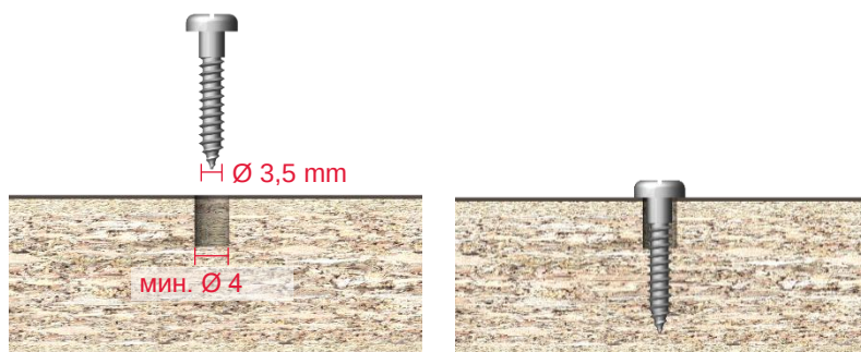
Фигура 9: Пример за винт 3,5 mm с предварително пробиване
