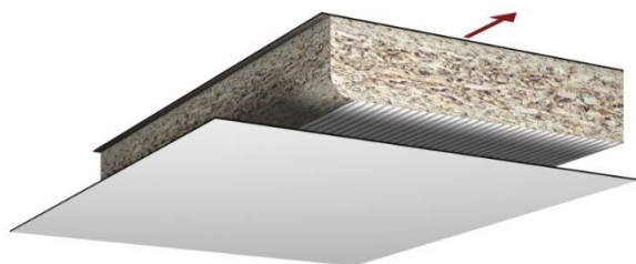
Мал. 34 Приклеювання паперово-шаруватого пластику до основи Малюнок 35: Виступ пластику
