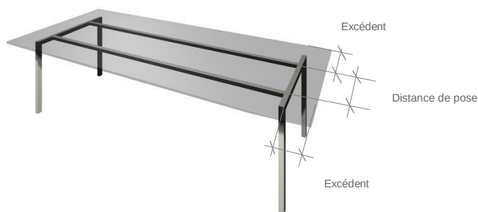
Image 17 : Excédent et distance de pose de plans de travail d'une table
