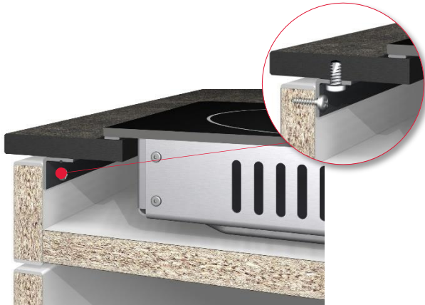
Rysunek 23: Metalowy trawers pod wycięcia
