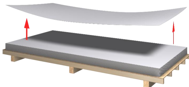
Figura 9: sollevamento dei laminati
