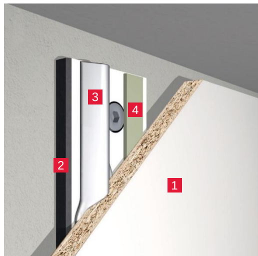
Figura 53: adesione a una sottostruttura di pannelli stratificati
