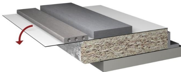
Figura 30: postformatura tramite guida metallica mobile
