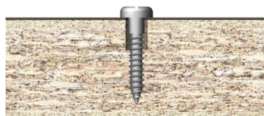
Figura 19: giunto a vite con preforatura
