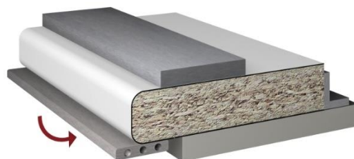
Figura 30: postformatura tramite guida metallica mobile
