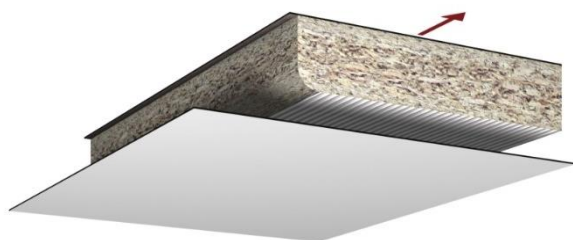
Figura 34: incollaggio del laminato al pannello di supporto
