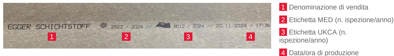
Figura 7: stampa a iniezione sul lato posteriore del laminato
