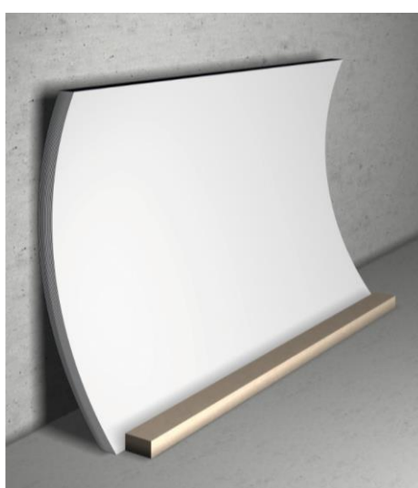
Figura 6: laminati conservati in modo errato
