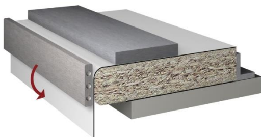
Figure 31: postformatura del laminato
