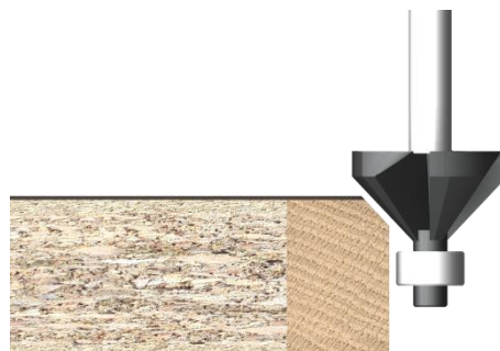
Fresa a smusso con anello di spinta
