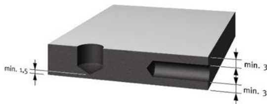
Obrázek 5: Minimální vzdálenosti vrtaných otvorů od okraje desky
