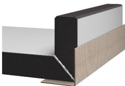
Obrázek 18: Vyklopení lemu a jeho zajištění lepicí páskou
