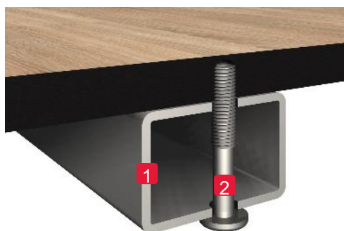
Obrázek 41: Doporučený způsob upevnění stolové desky z kompaktní desky
